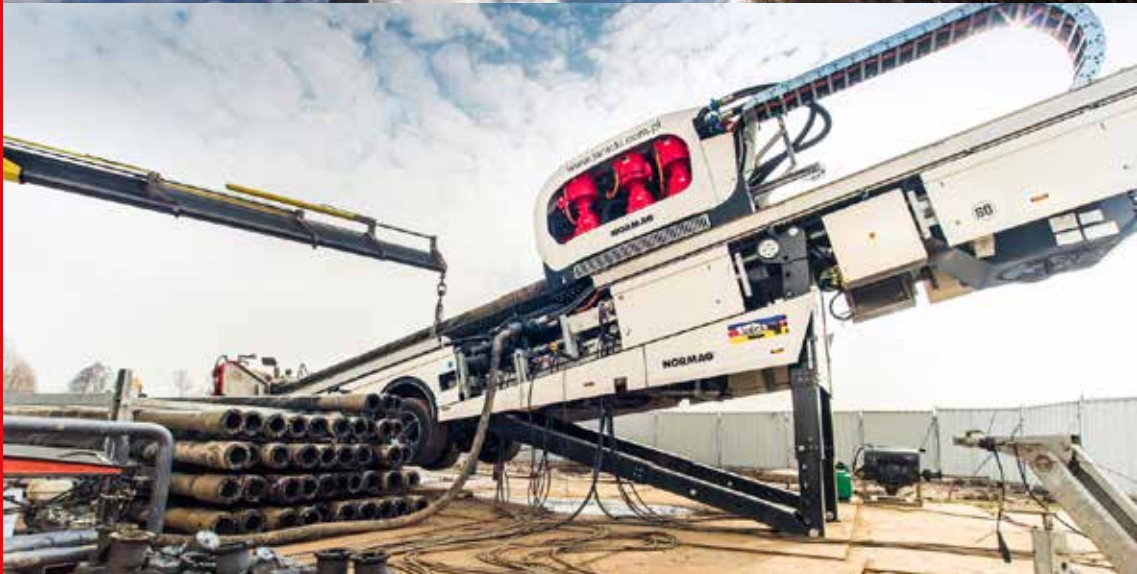
Ylin kuva: UPM Lappeenrannan biojalostamo on maailman ensimmäinen kokonaan puupohjaista dieseliä ja naftaa valmistava biojalostamo. Alin kuva: Normag hybridi vaakapora hyödyntää Danfoss Mobile Electrification hybriditekniikkaa, mikä vähentää energiankulutusta ja päästöjä.
